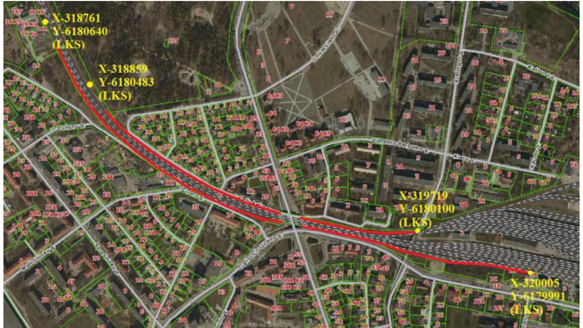
1 pav. Preliminari nagrinėtinų triukšmą mažinančių priemonių (pvz. triukšmo užtvartų, pažymėta raudona linija) vieta ir analizuotinos teritorijos koordinatės. Tikslios priemonės ir jų vieta turi būti parinkta pagal triukšmo matavimų ir modeliavimo rezultatus, įvertinus technines ir teises priemones įrengimo galimybes bei kitas aplinkybes.
